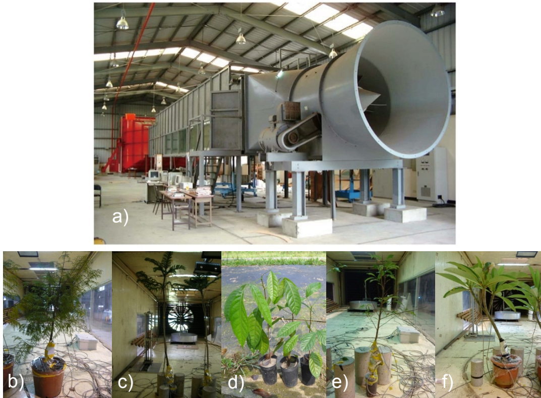
Fig. 1. Experimental set-up. a) External view of wind tunnel; b) Chamaecyparis obtusa var. formosa ; c) Araucaria cunninghamii ; d) Swietenia mahagoni ; e) Michelia formosana ; and f) Plumeria acutifolia
